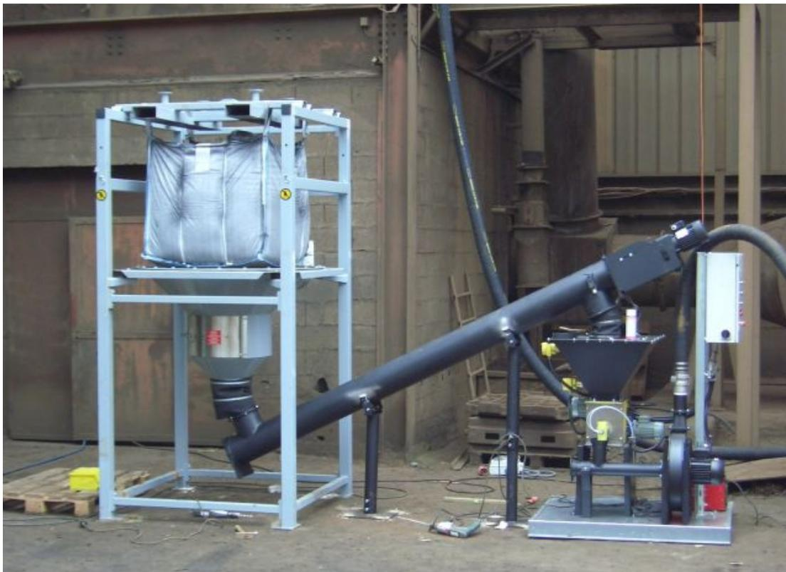
**Abbildung 20. Blick auf eine Installation zum Einblasen von Adsorbenten**
