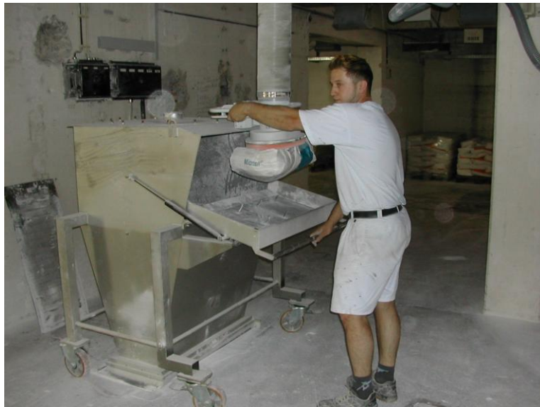
Abb. 3: Sack-Entleerstation
