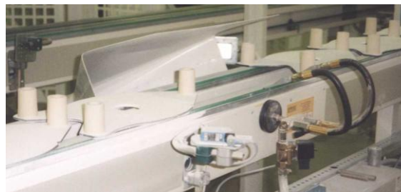
Abb. 2: Kombinierte Blas-/Saugvorrichtung zur Reinigung von Brennhilfsmitteln
