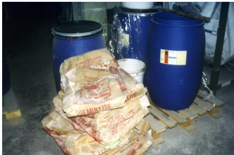
Abb. 4: Staubquelle durch die Lagerung leerer Papiersäcke
