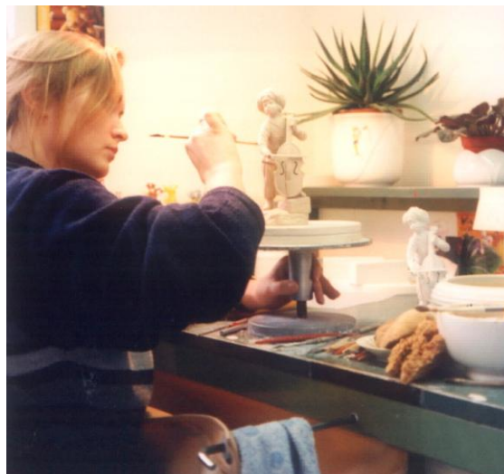
Abb. 1: Modellier und Putzarbeitsplatz mit Auffangsack
