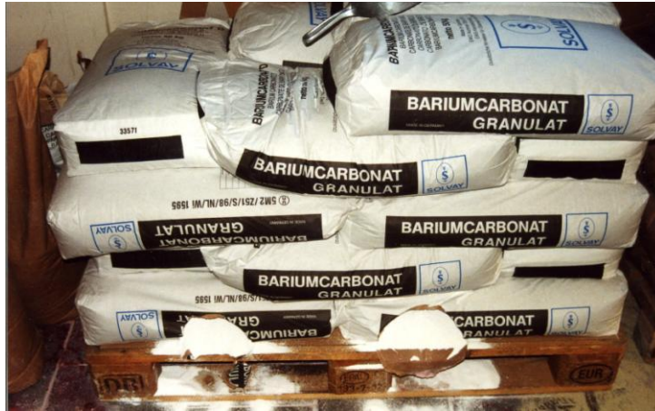
Abb. 2: Durch innerbetrieblichen Verkehr beschädigte Bariumcarbonat-Säcke; der Rohstoff liegt als Granulat vor
