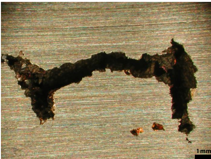
Bild A 1.3.1 Porenausbildung im Sandguss (CuSn 12Ni2)
