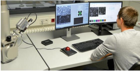
Modernes Rasterelektronenmikroskop mit EDX, welches mit geringerem Vakuum arbeitet und damit auch die Untersuchung von bentonitgebundenen Formstoffen ohne Trocknungseffekte ermöglicht
