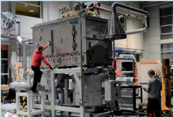
An einer im Rahmen eines Verbundprojektes mit industriellen Partnern entwickelten Versuchsanlage können partikelverstärkte Aluminiumlegierungen im Feinvakuum gegossen werden
